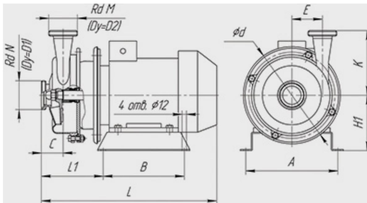
На рисунке насос с двигателем общепромышленного исполнения с одинарным торцевым уплотнением.
